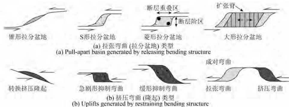
图3 走滑断裂挤压弯曲与拉张弯曲结构示意图(Mann, 2007)
